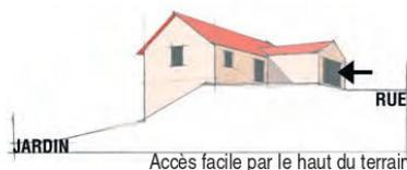
Il est intéressant de sortir du schéma classique d'organisation de la maison avec le garage en sous-sol et l'habitation au dessus. En effet, dans ce cas, l'accès par le haut du terrain oblige une grande boucle de chemin d'accès au garage, au détriment du jardin d'agrément.
