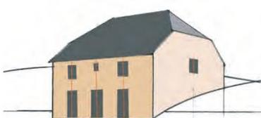
Une fenêtre peut être transformée en porte vitrée pour apporter juste un peu plus de lumière (le linteau qui est la pièce la plus difficile à transformer reste ainsi en place)
